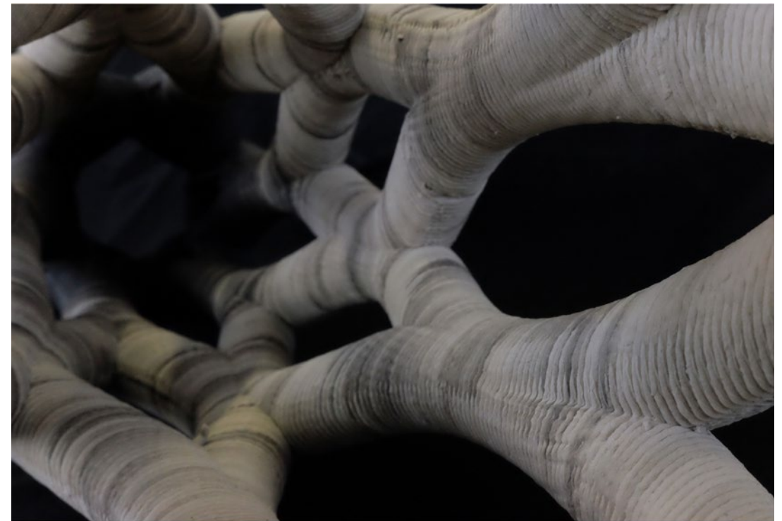
João Moreira. “Coluna FICUS. Protótipo de um sistema reticulado e tubular de coluna biomimética”. 2018. “FICUS column. Prototype of a reticulated and tubular biomimetic column system”.
